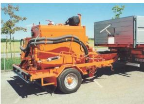
3. Le séchage et le nettoyage des dégradations L'étape la plus importante de tout le processus de réparation sont le nettoyage et le séchage de la degradation à l'air comprimé assurés par une buse spéciale intégrée dans la tête de mélange.
